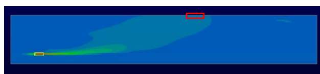
図 10 流速分布（水温差 3℃ D=27.6\text{m} ）
