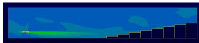
図 21 流速分布 (水温差 3°C S=22\text{m} )
