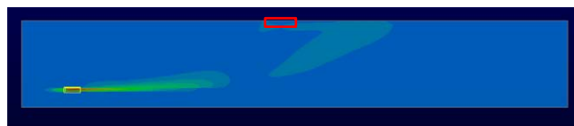
図 9 流速分布（水温差 3℃ D=18.4\text{m} ）
