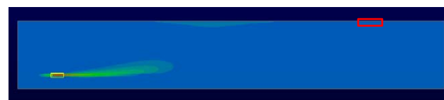
図 11 流速分布（水温差 3℃ D=36.8\text{m} ）
