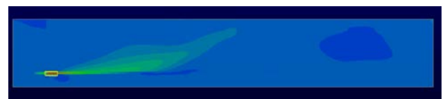
図5 流速分布 (温度差 3°C)
