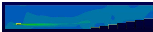
図 22 流速分布 (水温差 3°C S=25\text{m} )
