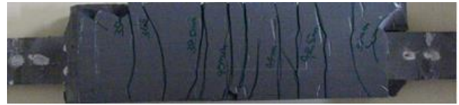
Fig.4.2 鉄筋を用いた供試体の破壊性状
