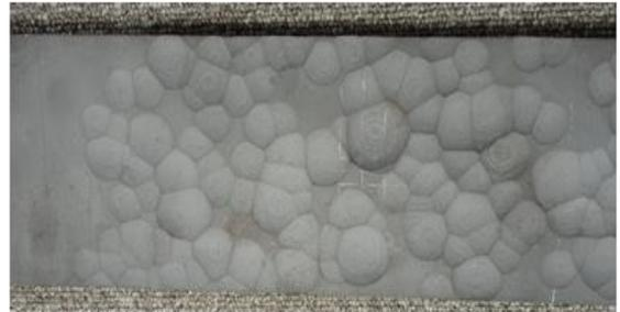
写真 1 表面腐食写真
