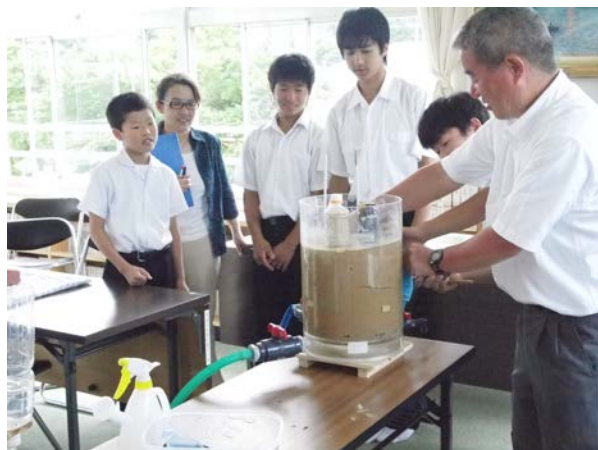
写真-3 地盤の液状化実験 (佐々波中学校・上)
