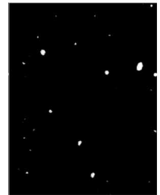
図 - 3 圧力測定フィルムのモノクロ化
