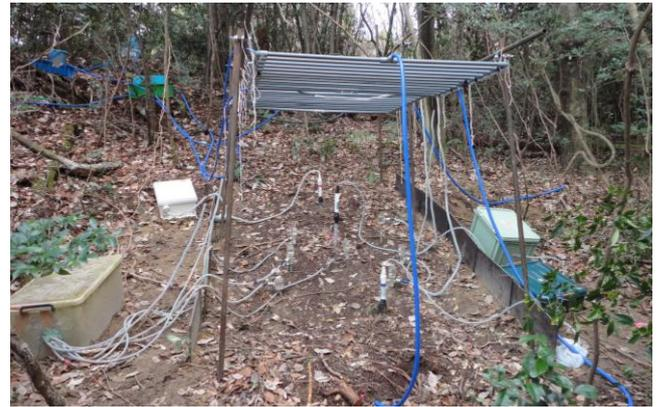
写真-1 降雨装置の設置状況
