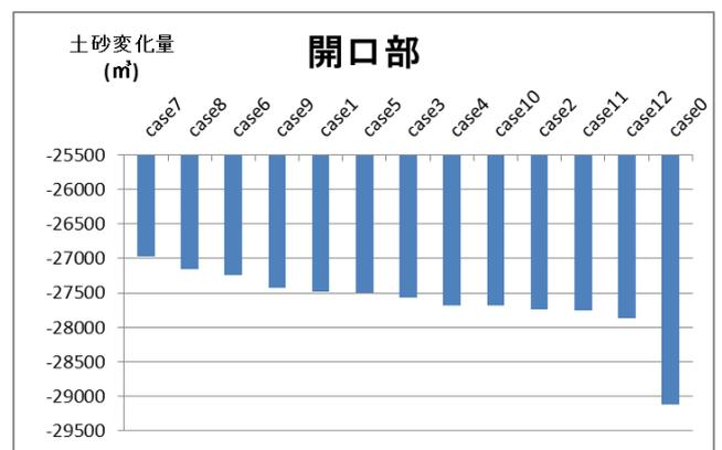
図-7 人工リーフ開口部の侵食量の比較
