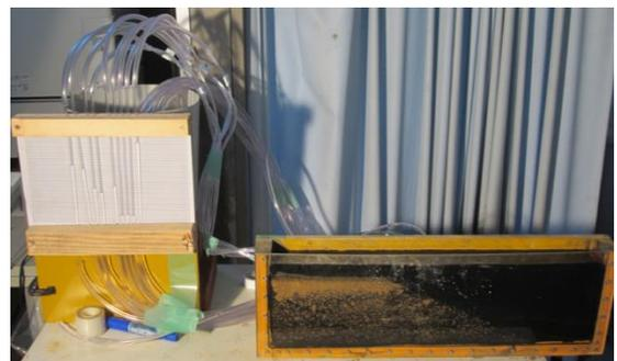
図-2 実験装置(右側が浸透中の土槽, 左側は堤体内の圧力計測用ピエゾ管)
