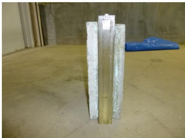
図-3 パラフィン供試体とモルタル版の積層構造
