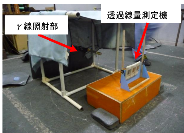
図-4 \gamma 線照射装置と測定装置
