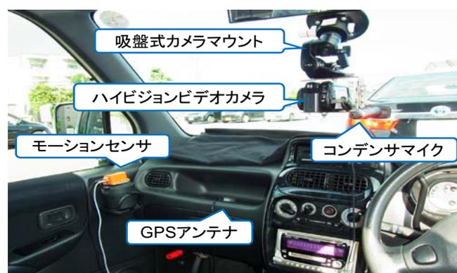
図2 測定機材の配置例
