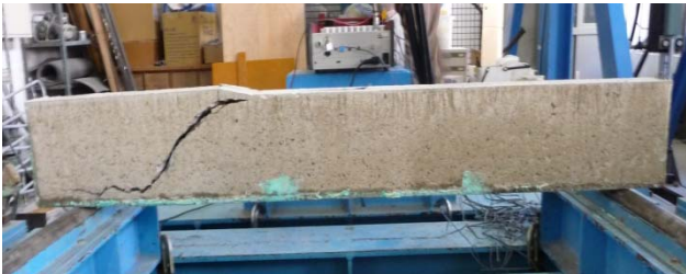
写真-1 Sg100 のひび割れ状況
