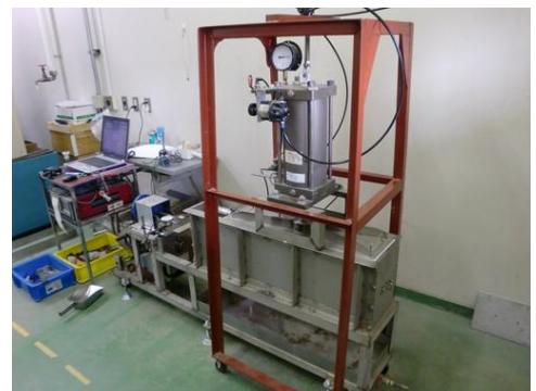
写真-1 引抜き試験装置
