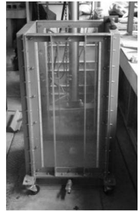
写真-1 ベロフラムシリンダーの載荷板と締固め土槽
