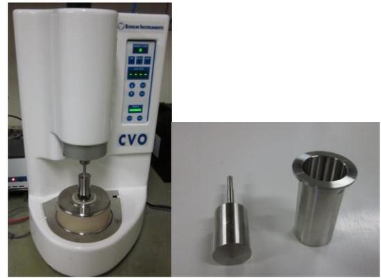
写真-1 共軸二重円筒型粘度計(左)とボブ&カップ(右)
