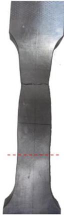
写真-1 フランジ1の破断状況
