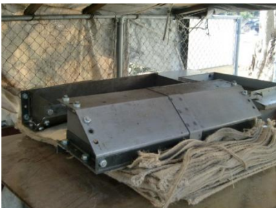
写真 9. 車止めブロックの型枠
