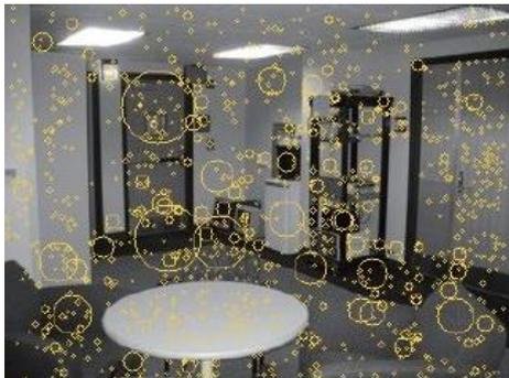
図-2 特徴点の例<sup>2)</sup>(円の中心は特徴点の位置、円の大きさは特徴量の大きさを示す。)
