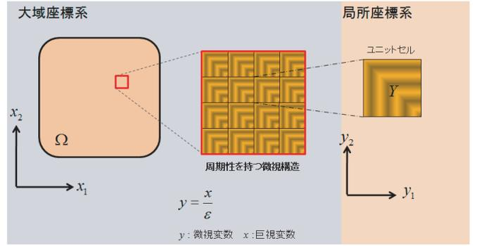
図-1 均質化法における大域 (マクロ) および微視 (ミクロ) 構造の概念。
