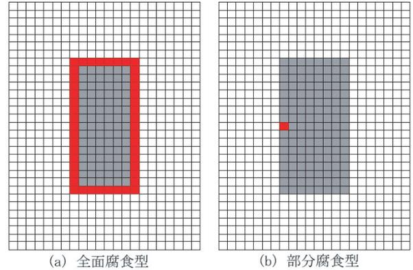
図-2 マクロ解析モデル．網掛けした部分がオーバーパックを，黒く塗りつぶした部分が腐食による溶出が起こると仮定した箇所を示す．
