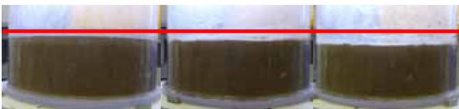
超音波なし      超音波40W      超音波600W
