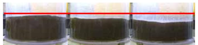
超音波なし      超音波40W      超音波600W
