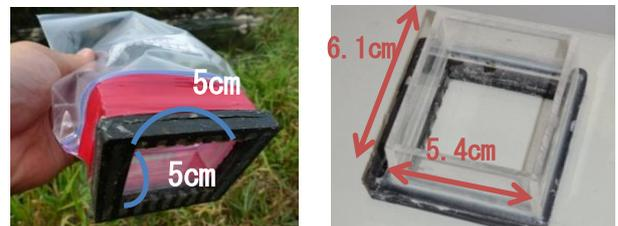
図-2 巨礫の付着藻類の計測器
