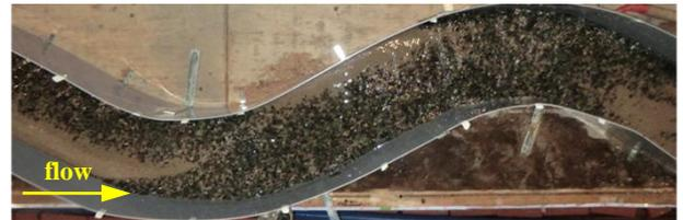
写真-2 実験後の河床表面 (CaseD-1)
