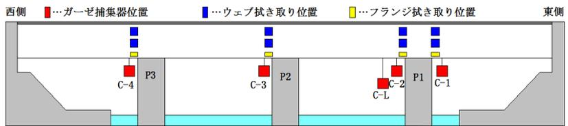
図-2 橋軸方向における試験位置
