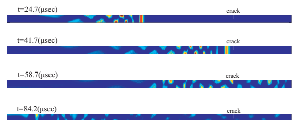
図-3 板内部に発生する速度場のスナップショット。
