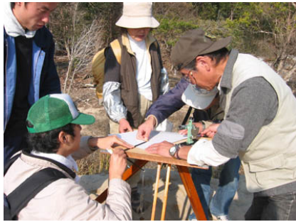
(a) 平板測量で地図を作成
