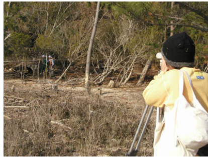
(b) レベルを用いた地形測量
