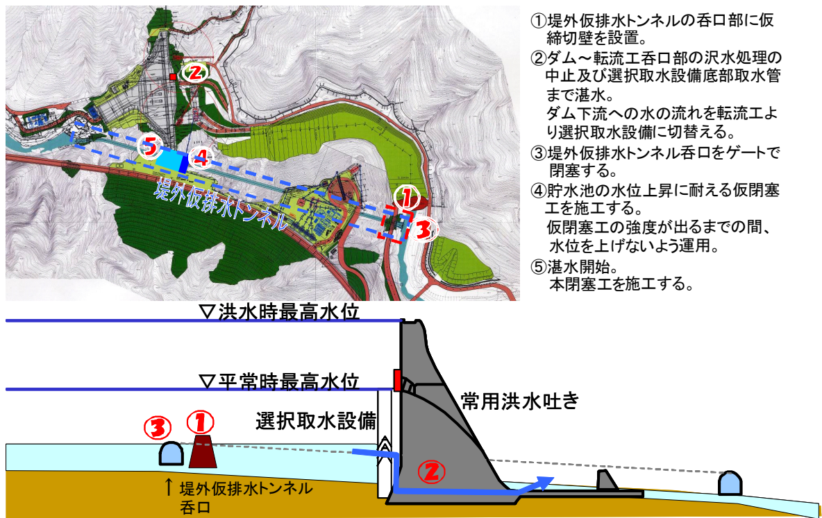
図 4 - 1 閉塞工閉塞準備以降の実施手順の概要
