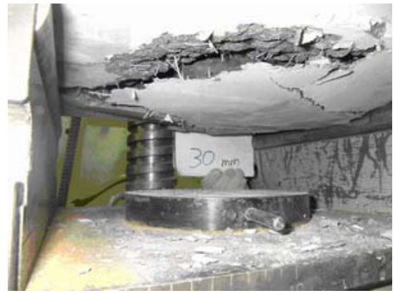
写真2 押抜き試験の様子(変位 30mm 時)
