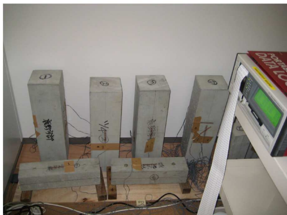
写真-2 ひずみゲージによる測定の様子
