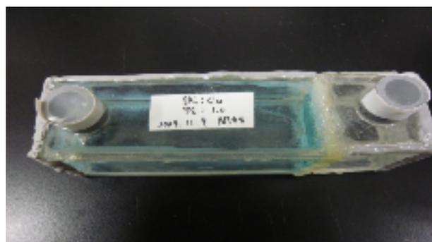
図-1 拡散試験装置
