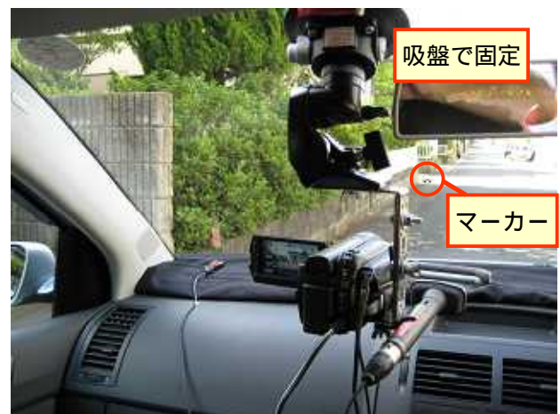
図 1. マーカーとカメラの設置状況
