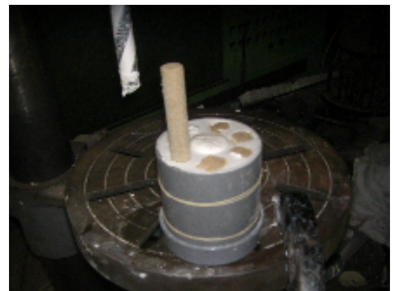
図-2 杭の差し込み
