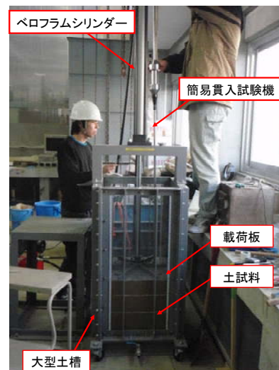
写真-1 土槽実験の状況
