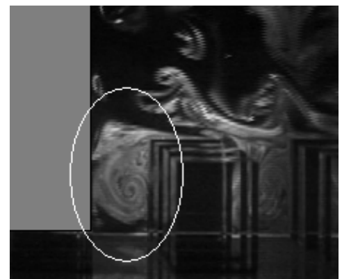
図-3 高層ビル前面の縦断面形象
