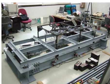
図-1 橋梁模型と加速度計の配置
