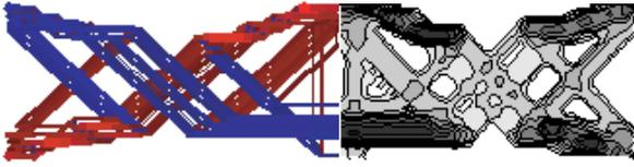
Fig. 2 形態形成の最適化解析結果 (20 × 80 分割)
