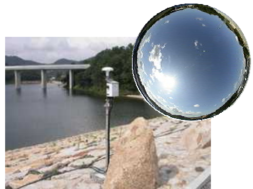
図-3 GPS センサーの設置状況と上空視界(E3)
