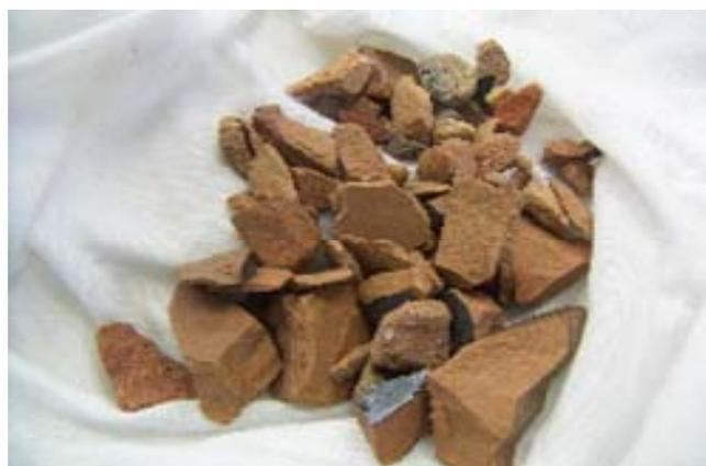
写真-1 廃瓦粗骨材
