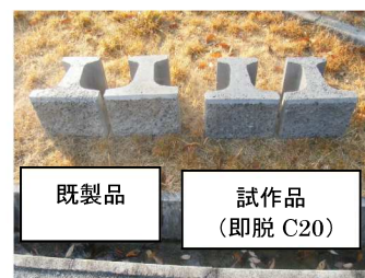
写真-3 積ブロック
