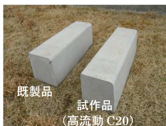
写真-2 歩車道境界ブロック
