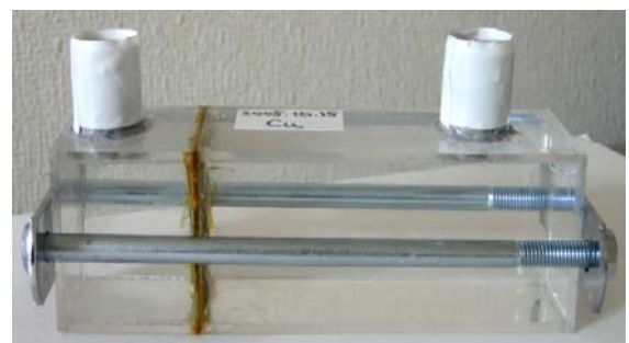
写真 1 拡散セル試験装置（濃度勾配）
