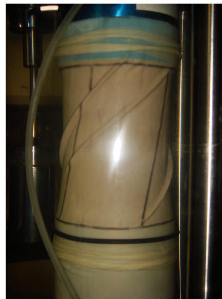
写真-2 載荷後の供試体
