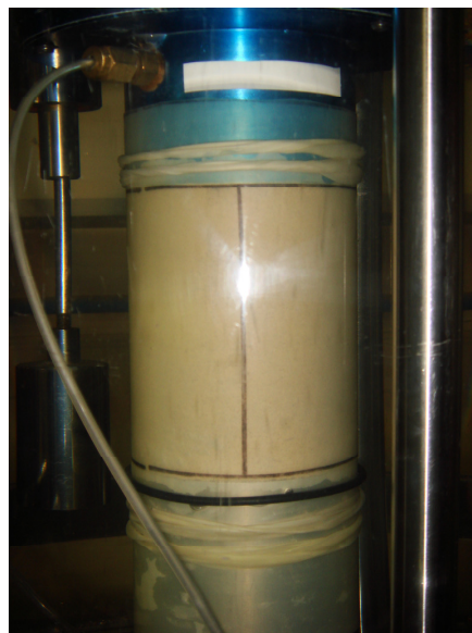
写真-1 載荷前の供試体
