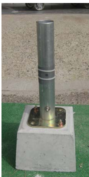
図-4 水位計の設置方法
