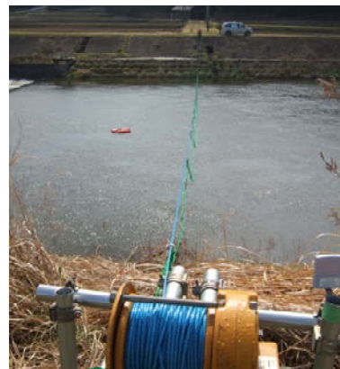
図-7 ADCP を用いた流量観測風景
