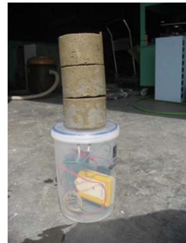
図-10 設置した洗堀深計の外
