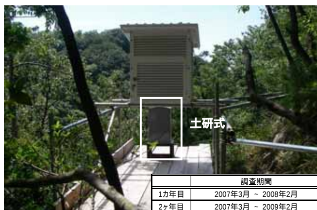
写真-2 A 橋 (百葉箱設置状況)
