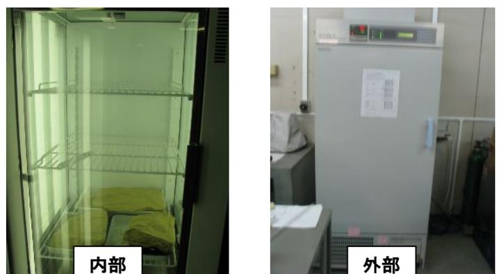
写真 1 栽培実験に用いたインキュベーター
