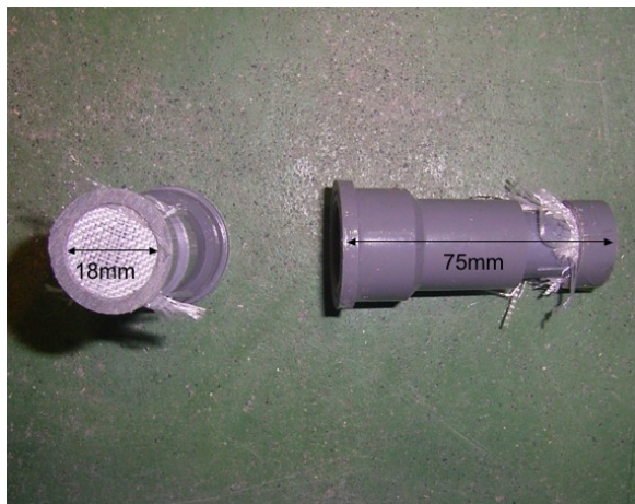
写真1 コンクリート中の自由水を採取する排水口
