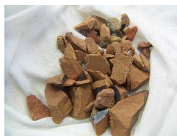
写真-1 廃瓦(3日間吸水)
