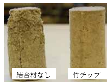
写真-3 凍結融解10回目の供試体
