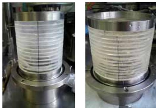
写真-1 積層リング内蔵モールドの写真
