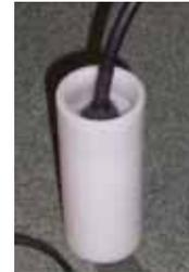
写真-1 水位計1 (水圧式水位計)
