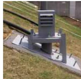
写真-5 水位計2 (設置状況)
