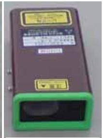
写真-4 水位計2 (レーザー変位計)
