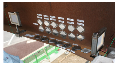
写真-1 暴露試験片設置状況
