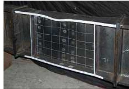
Photo3 C87 崩壊状態
