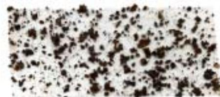
図-10 G2 下フランジ下面 評価レベル 2
