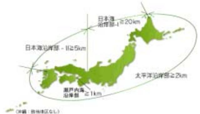
図-1 耐候性鋼橋梁適用区分
